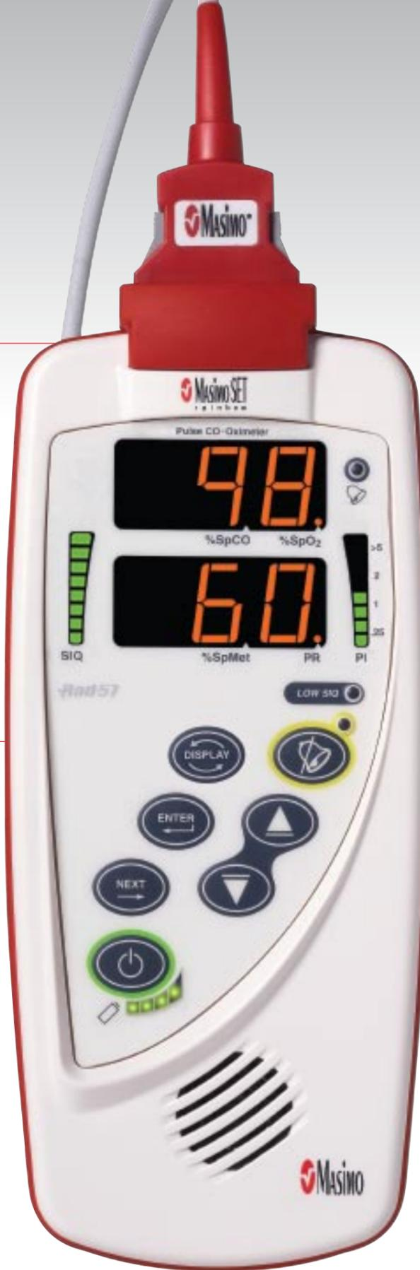
En la imagen aparece el Rad-57 en el modo SpO<sub>2</sub>. Las características de la pantalla variarían según las mediciones no invasivas cargadas en el dispositivo.
